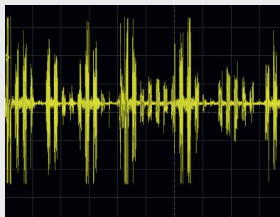
Hier hat ein Stimmenverzerrer den gesprochenen Satz regelmäßig mit einer Frequenz von ca. 10 Hz unterbrochen. Dadurch entsteht ein roboterartiges Sprachbild.
