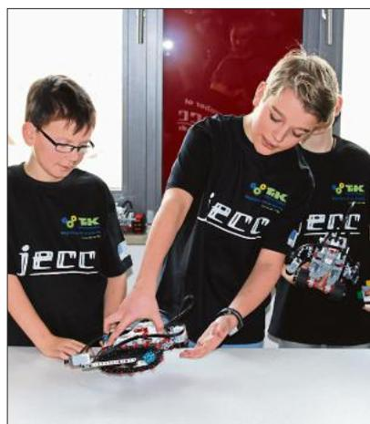
Sensoren verhindern, dass dieser Roboter über die Tischkante stürzt.
